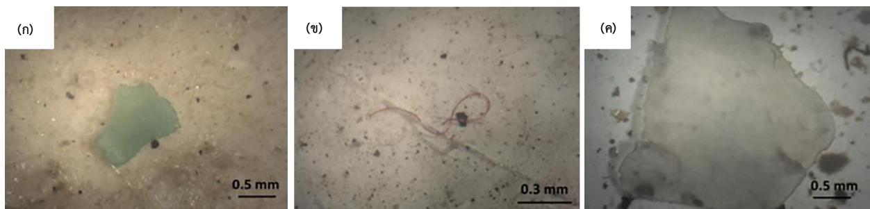
รูปที่ 2 ภาพแสดงไมโครพลาสติกทุติยภูมิชนิดต่าง ๆ ได้แก่ (ก) ชิ้นส่วน (Fragment) พลาสติก (ข) เส้นใย (Fiber) พลาสติก และ (ค) ฟิล์ม (Film) พลาสติก
