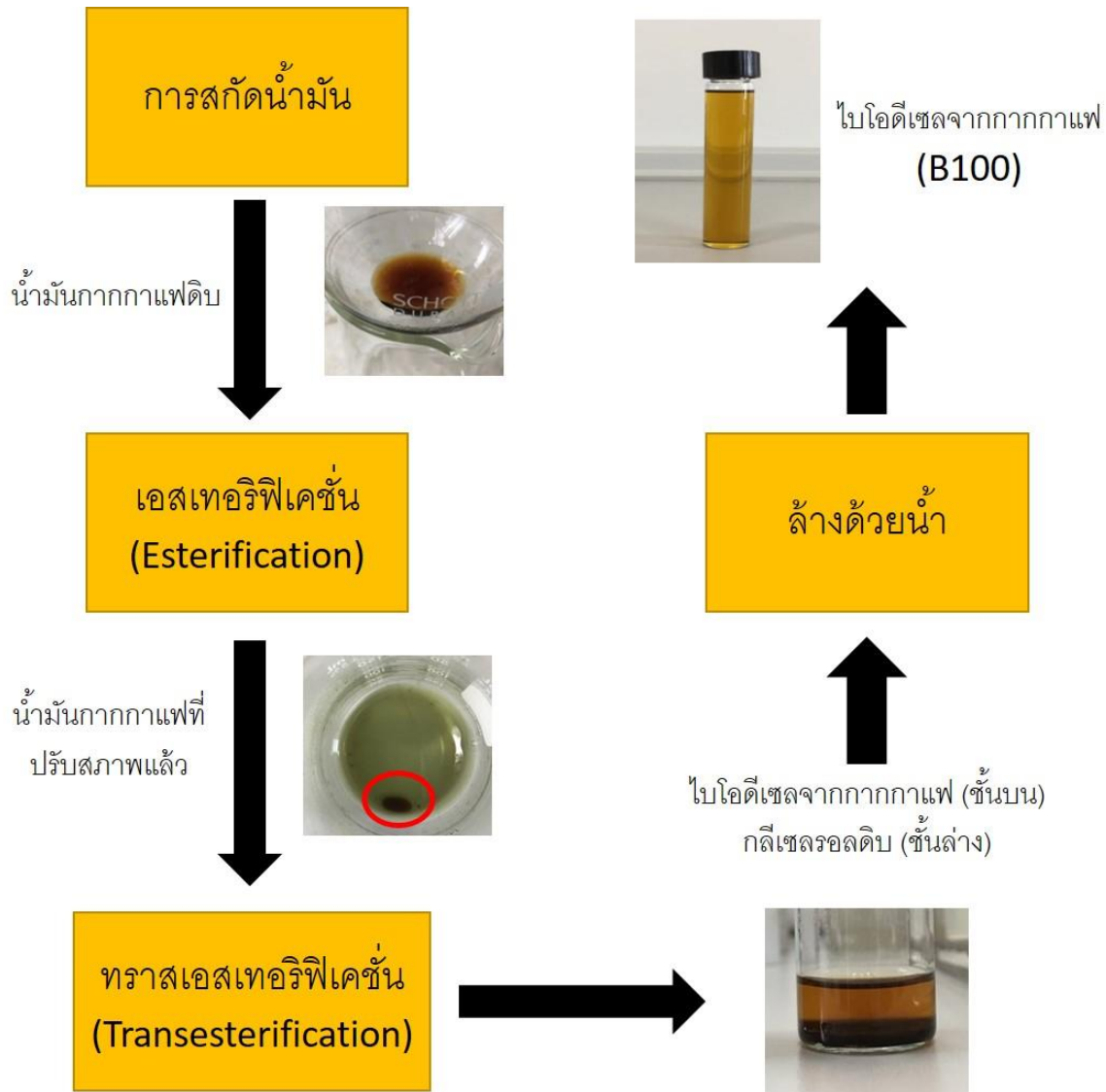
รูปที่ 2 กระบวนการผลิตไบโอดีเซลจากกากกาแฟ
