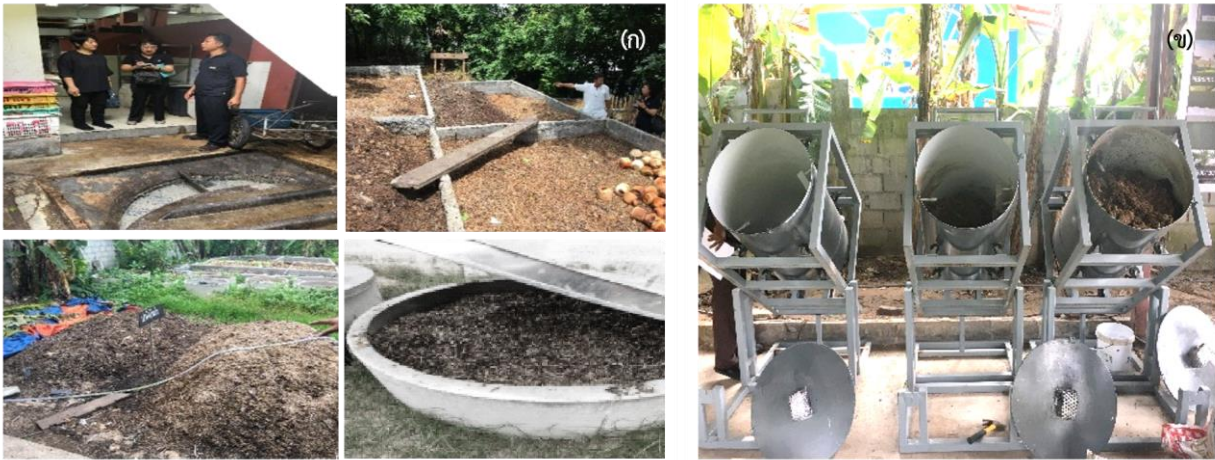
รูปที่ 4 (ก) วิธีการจัดการกากไขมันปัจจุบันของอุตสาหกรรมโรงแรมในเกาะสมุย และ (ข) ถังหมักกากไขมันต้นแบบเพื่อใช้แปรรูปกากไขมันเป็นปุ๋ยหมัก
