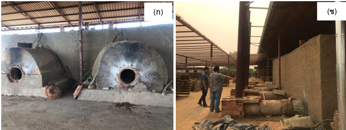
รูปที่ 2 แสดงภาพเตาเผาอิฐมอญแบบถมทรายหลังเตา (ก) ด้านหน้าเตาเผา และ (ข) ด้านหลังเตาเผา
