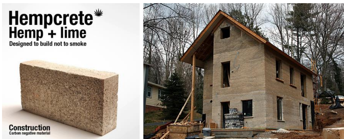
รูปที่ 1 คอมโพสิตเฮมพ์-ไลม์ หรือ เฮมพ์คอนกรีต ที่มา: http://cargocollective.com/futurehealth/Hempcrete
