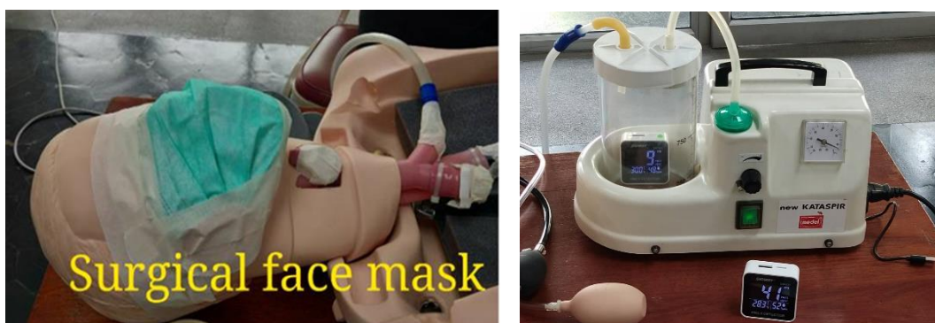
รูปที่ 1 ระบบการทดลองประกอบด้วยหุ่นฝึกปฏิบัติการทางการแพทย์ครอบงมด้วยหน้ากากที่ต้องการทดสอบและเครื่องดูดเสมหะจำลองการหายใจ
