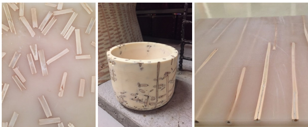
รูปที่ 6 วัสดุผสมหินเทียมกับแกนเฮมพ์ การทดลองพัฒนาวัสดุของนิสิตในการออกแบบวัสดุเหลือทิ้ง
