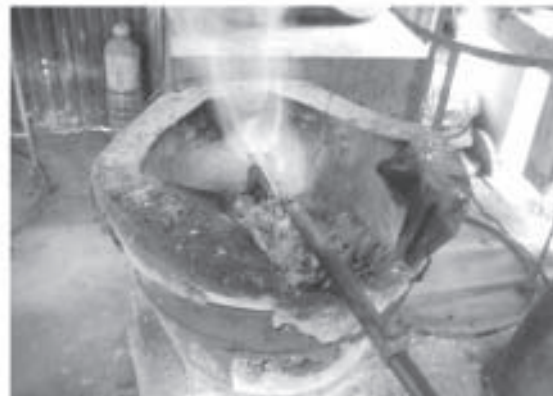
ภาพที่ 5 แสดงการแก้ปัญหาหัวเตาจุดดับบ่อยโดยใช้หัวเตาแบบท่อเหล็กแทน
