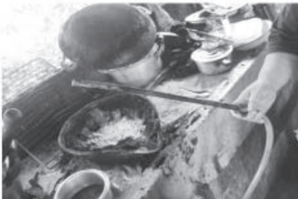
ภาพที่ 5 แสดงการแก้ปัญหาหัวเตาจุดดับบ่อยโดยใช้หัวเตาแบบท่อเหล็กแทน
