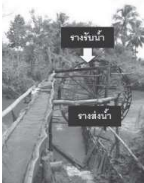
ภาพที่ 3 รางรับและรางส่งน้ำของระหัดวิดน้ำ ที่มา : ปรับปรุงจาก http://www.oknation.net/blog/navycom/2008/07/29/entry-2
