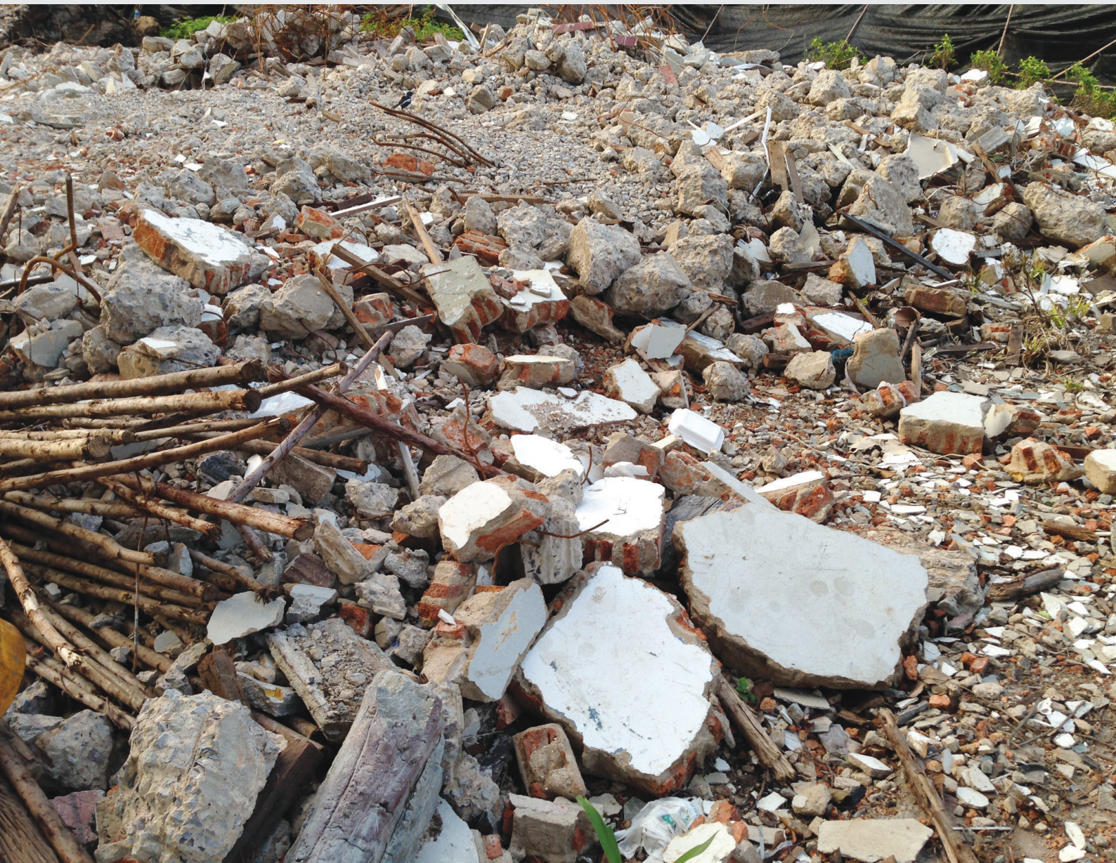
รูปที่ 1 ภาพตัวอย่างของเสียจากการก่อสร้างและรื้อถอน
